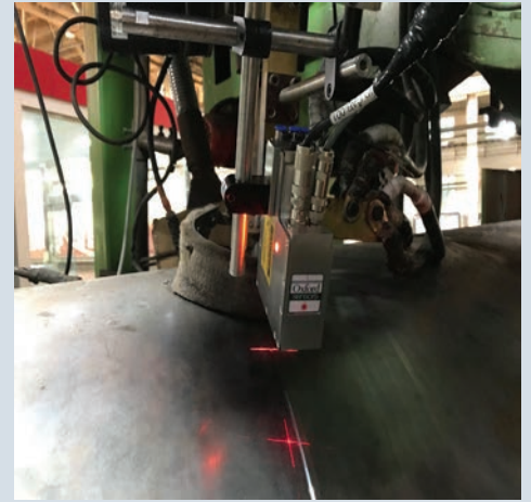
螺旋焊管外焊
